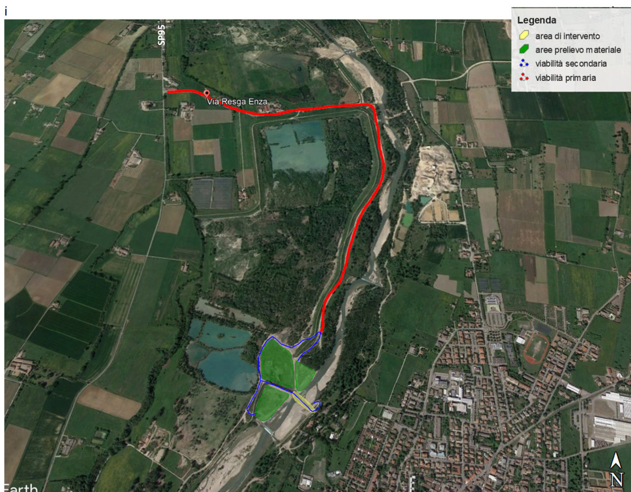
Fig. 10 – viabilità di cantiere con individuazione aree di prelievo del materiale
